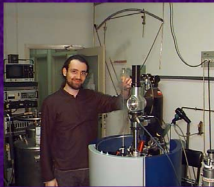
Criostat per a la mesura de magnetització, resistivitat, i calorimetria fins a temperatures de 1 Kelvin i camps magnètics de 9 Teslas
